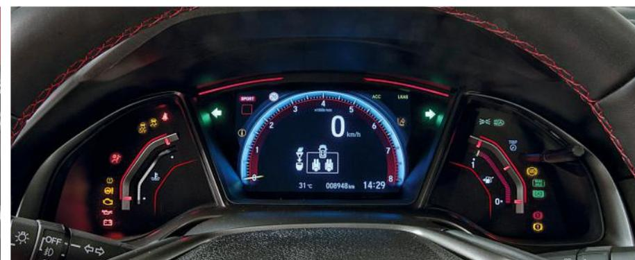
Il display permette di disporre anche d'informazioni supplementari, come la pressione del turbo e il valore di g laterale
