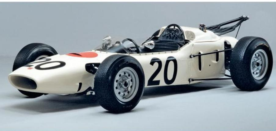
La RA271 del 1964 (sopra), con i caratteristici scarichi alti del motore (a destra), che è un V12 di 1.5 litri: ha basamento di lega leggera e potenza iniziale di 220 CV
