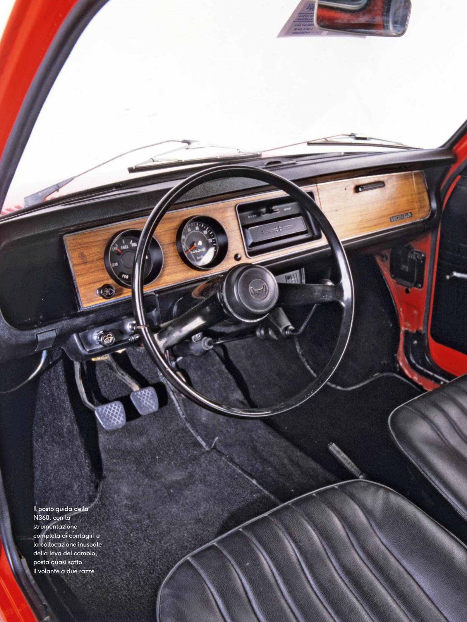
Il posto guida della N360, con la strumentazione completa di contagiri e la collocazione inusuale della leva del cambio, posta quasi sotto il volante a due razze
