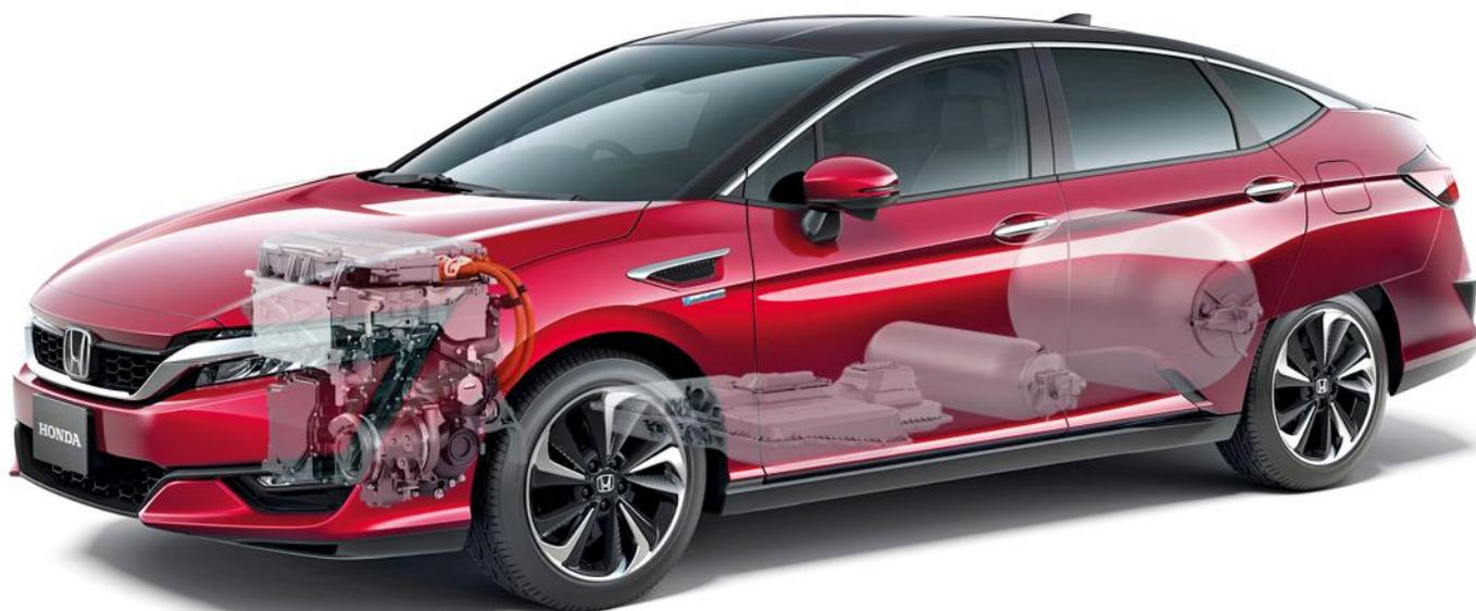
Lo schema tecnico della FCX Clarity a fuel cell del 2017: in evidenza i serbatoi ad alta pressione dell'idrogeno. Il motore elettrico ha una potenza di 130 kW, le batterie sono agli ioni di litio
