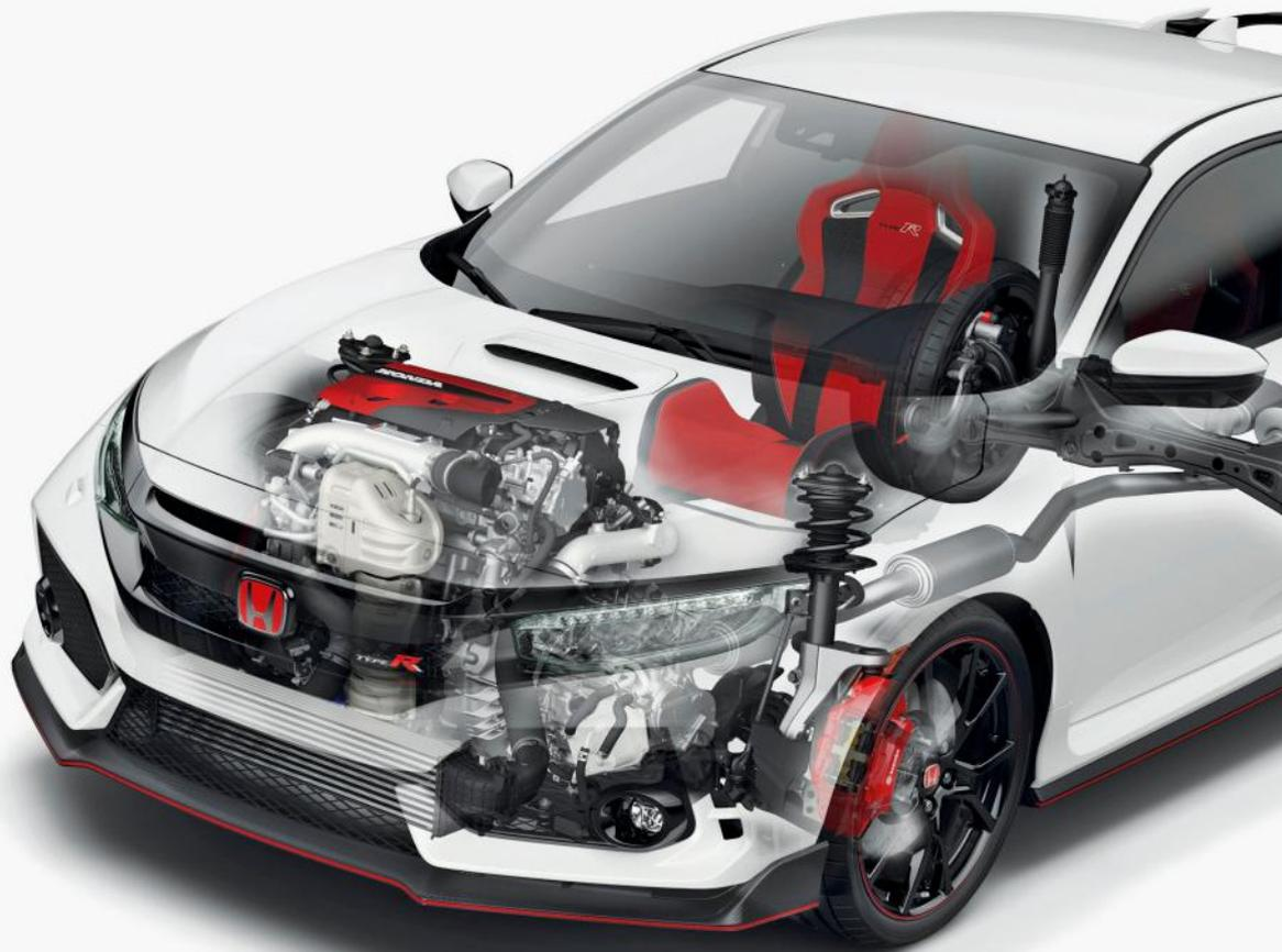
Lo schema tecnico è tradizionale: motore anteriore trasversale, trazione anteriore. A rendere speciale la Type R è piuttosto il fine tuning di assetto e sospensioni, che le dona un carattere inconfondibile
