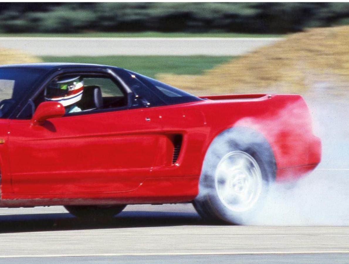
Ivan Capelli non si risparmia nel suo test della NSX, il cui comportamento giudica sempre corretto, sia nelle curve ad ampio raggio sia nei rapidi cambi di direzione, privo com'è di rollo e beccheggio. I pneumatici, presumibilmente distrutti nella prova, sono Yokohama (205/50ZR15 anteriori, 225/50ZR16 posteriori)
