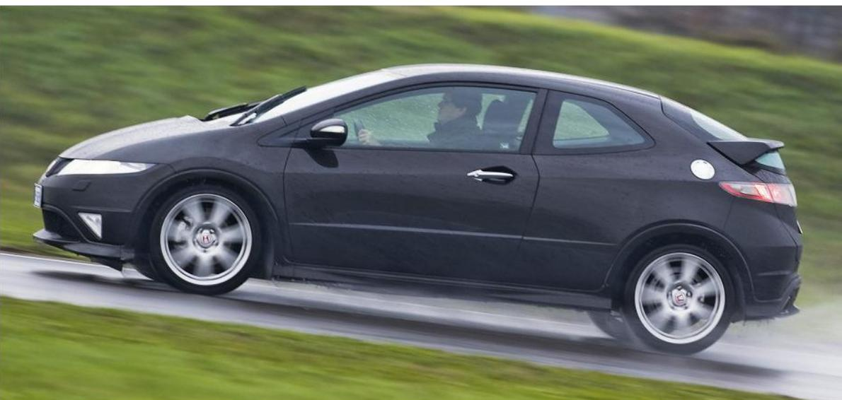
La Type R del 2007 (qui sopra, la versione con guida a destra) adotta un 4 cilindri aspirato di 2 litri con il consueto variatore di fase i-VTEC e potenza (per i mercati europei) di 198 CV; al retrotreno viene adottato uno schema a ponte torcente
